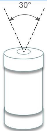
Le Ninox doit être placé à bonne distance d'obstacles hauts éventuels tels que des murs ou des arbres qui pourraient obstruer son champ de vision. Il est recommandé en particulier de ne pas placer le système Ninox à proximité d'une route (sauf pour des projets spécifiques) ou des fenêtres d'une habitation. Voici quelques exemples de Ninox **incorrectement installés** :
